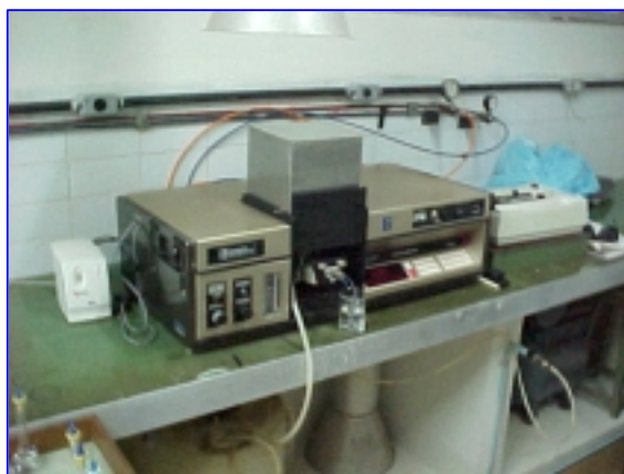
Figura 10 – Espectrofotômetro de Absorção Atômica modelo CG AA 7000 BC.
