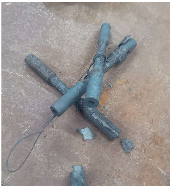
Figura 16: Preparação dos corpos de prova para a realização do tratamento térmico.
