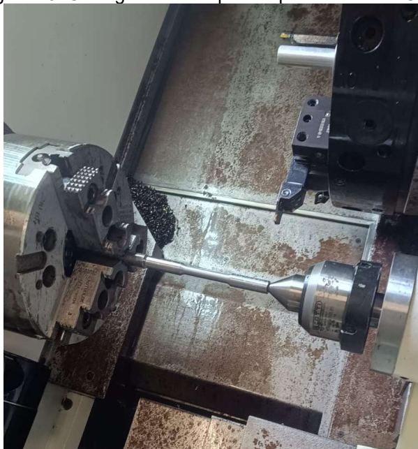
Figura 13: Usinagem dos corpos de prova no torno CNC.
