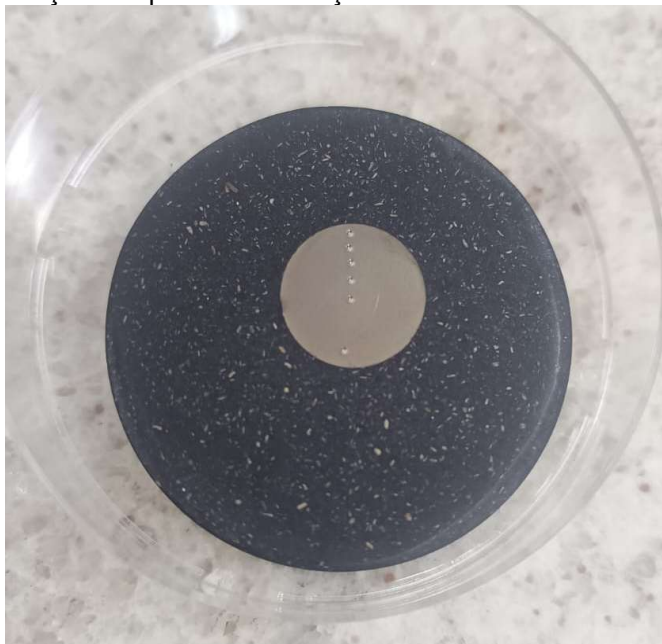
Figura 20: Localização dos pontos de medição do ensaio de dureza no corpo de prova.
