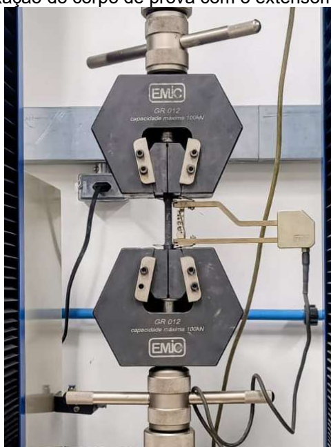
Figura 18: Fixação do corpo de prova com o extensômetro acoplado.
