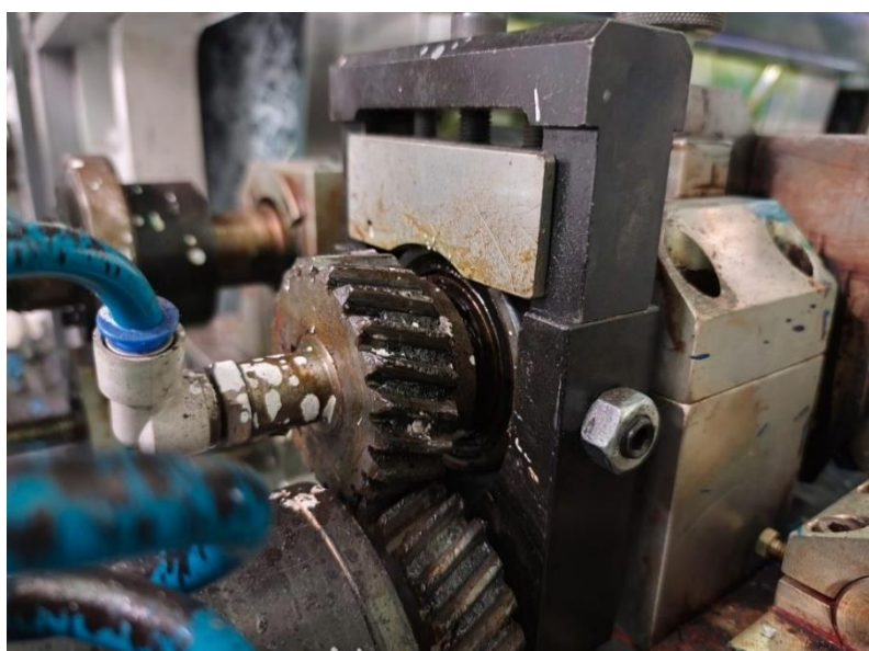
Figura 5 – Componente crítico: conjunto de rolamentos do anilox.
