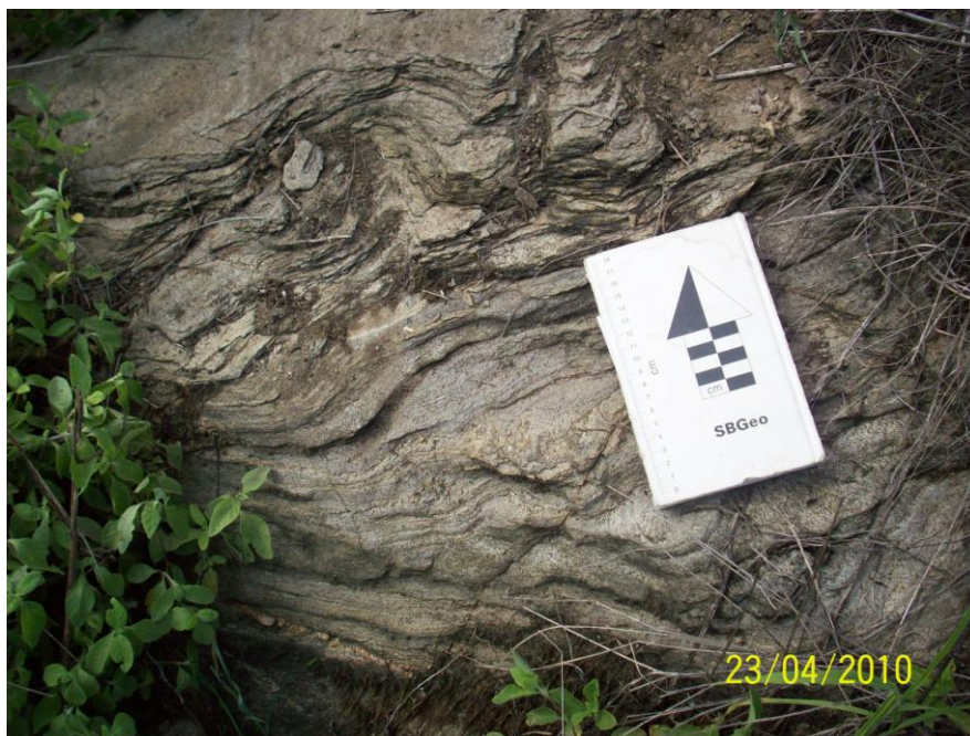
Figura 17 – Micaxisto Granatífero composto por biotita, muscovita, quartzo e porfiroblastos milimétricos a centimétricos de granada.
