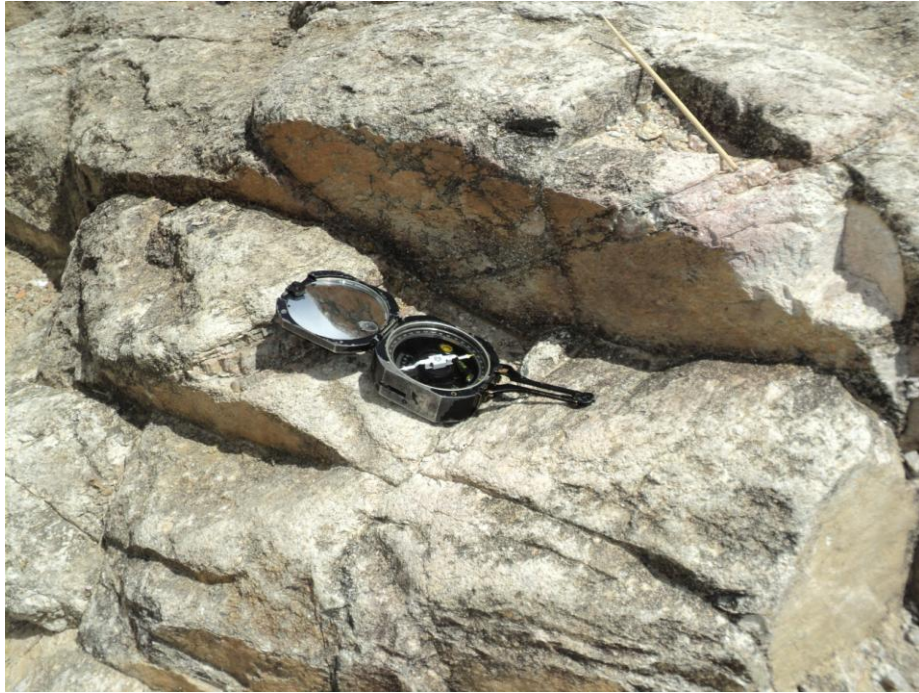
Figura 61 – Fraturas de direção NE subverticais.
