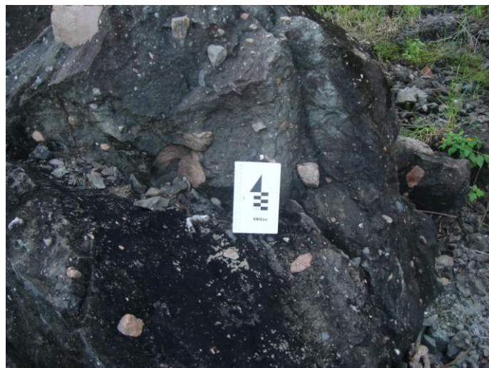
Figura 22 – Diamictito pertencente a Formação Batinga. É caracterizado por clastos imersos numa matriz siltico argilosa de coloração acinzentada, e distribuídos de forma dispersa.
