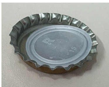
Figura 8 - Tampa com falha de aderência
