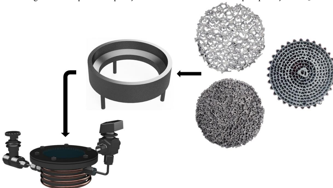
Figura 10 – Esquema da aplicação de catalisadores estruturados para produção de H_2
