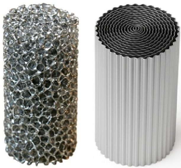
Figura 3 – Estruturas metálicas, sendo elas: espuma de alumínio (à esquerda); monolito de FeCrAl (à direita)
