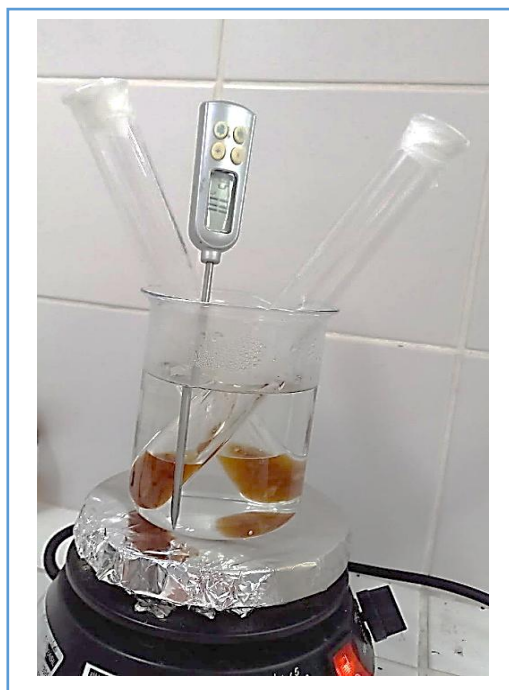
Figura 15 - Montagem para os testes de saponificação em banho maria, com tubos de ensaio macro vedados com Parafim, e termômetro digital
