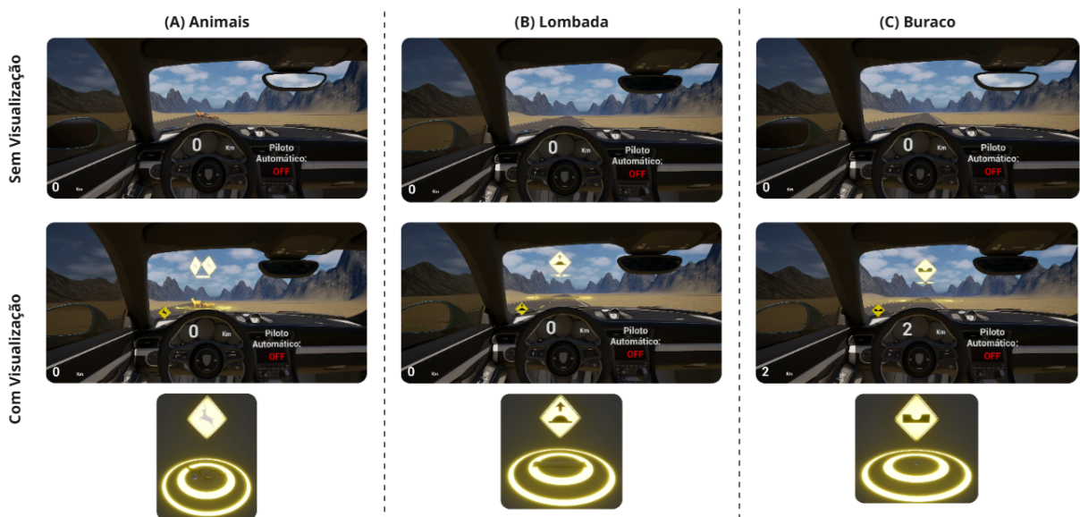
Figura 7 – Representação da visão do condutor com e sem as visualizações no WSD
