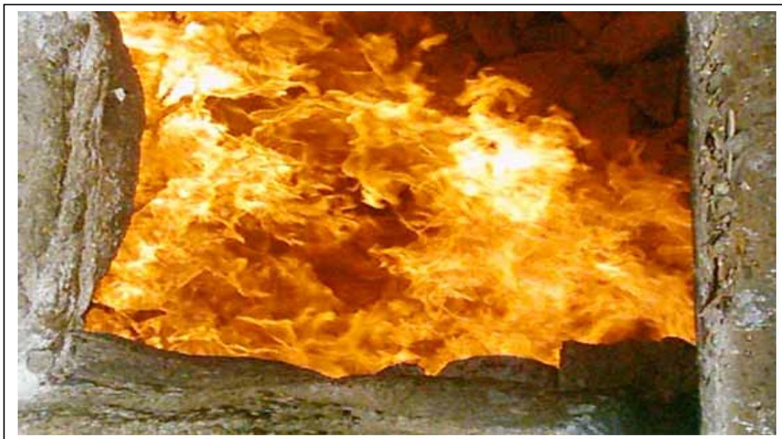
Figura 4 - Forno de calcinação em período de queima do calcário em Vertente do Lério – PE.
