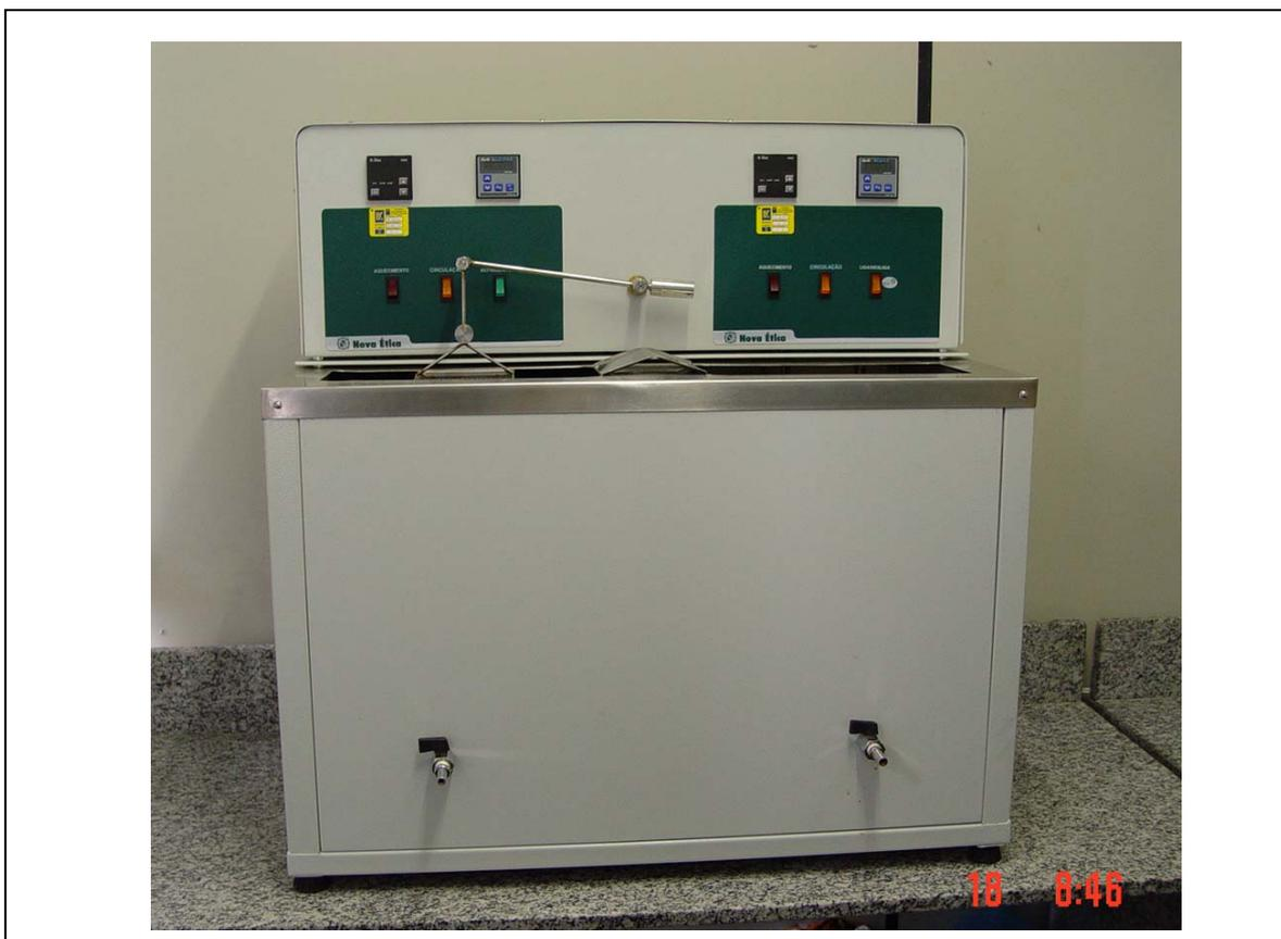
**FIGURA 6-** Máquina de ciclagem térmica: Banho para Teste Cíclico Série 521-4D<sup>®</sup> (Nova Ética Equipamentos Médicos Limitada)
