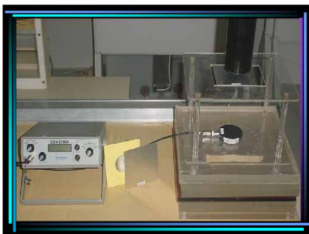
Figura 4: Arranjo experimental para a medida da CSR
