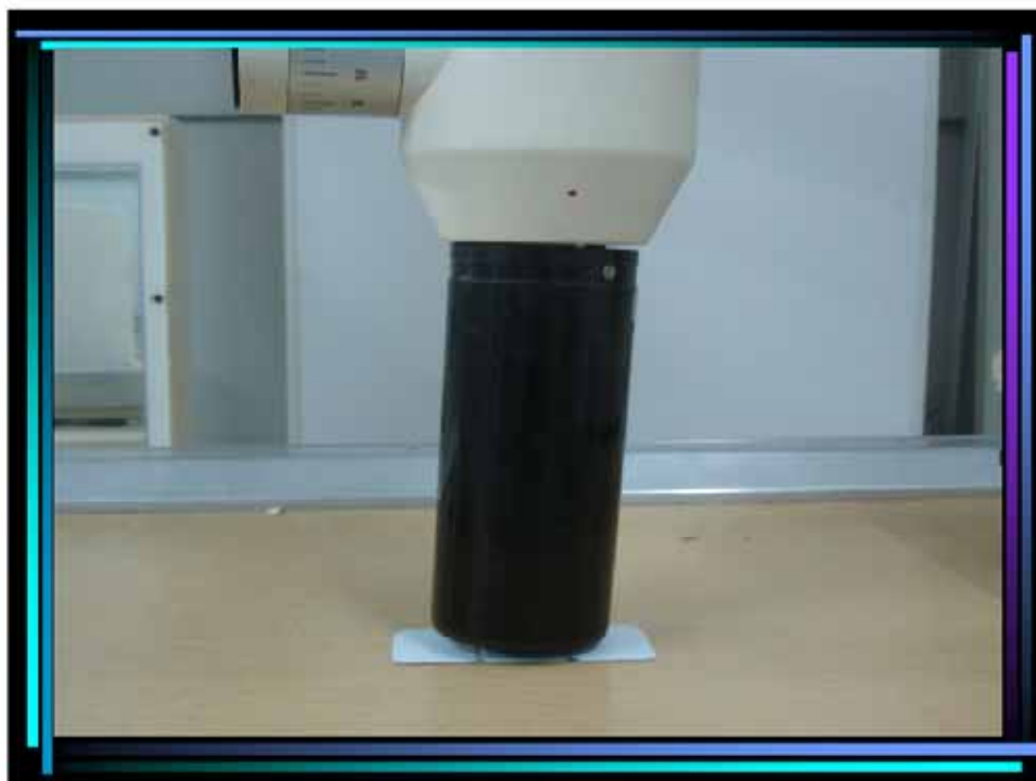
Figura 3: Arranjo experimental para determinação do tamanho do campo de radiação
