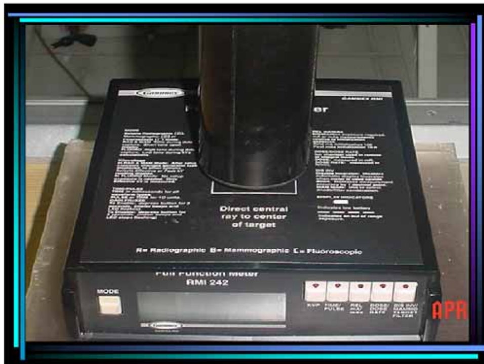
Figura 2: Arranjo experimental para medida do valor real da tensão e do tempo de exposição
