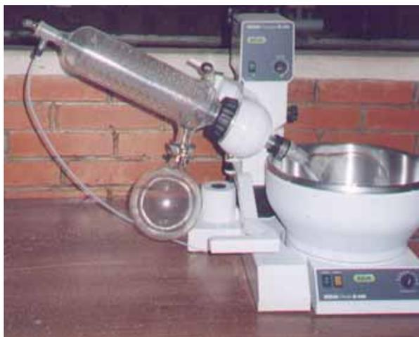
Fig. 2. Aparelho de Rota-vapor
