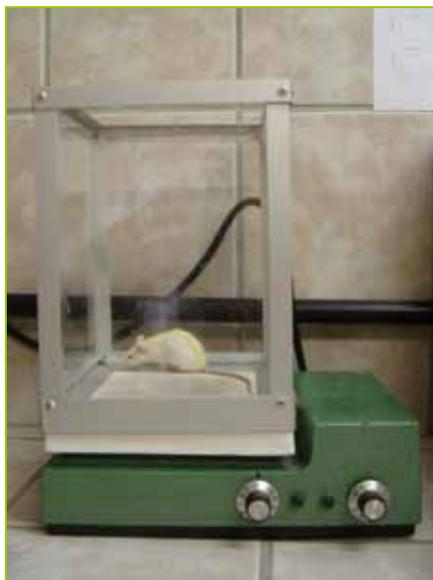
Figura 5 – Aparelho artesanal do Teste da placa quente
