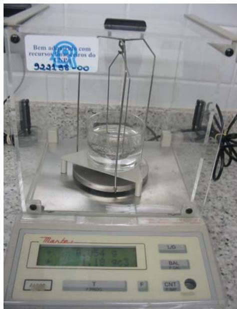
**Figura 5:** Balança de pesagem hidrostática para aferição da densidade do fêmur.
