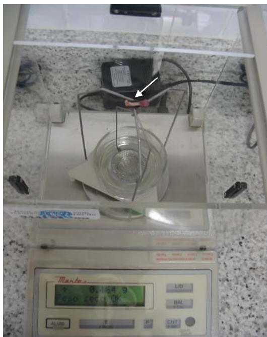
Figura 4 – Balança de pesagem hidrostática. Aferição do peso absoluto do fêmur.
