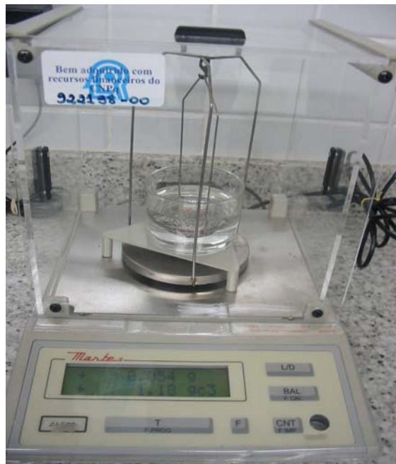
Figura 6 - Balança de pesagem hidrostática Aferição da densidade femoral.
