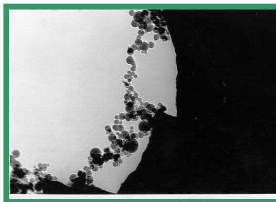
Figura 27. Nanoestrutura de agregados de sílica obtida nos experimentos, vista por meio da Microscopia eletrônica de Transmissão (TEM). FONTE: ABRAHAMSON, 2002.
