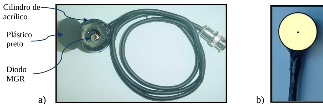
Figura 23: Foto do dosímetro com o diodo CERN MGR. a) Sensor aberto. b) Sensor fechado
