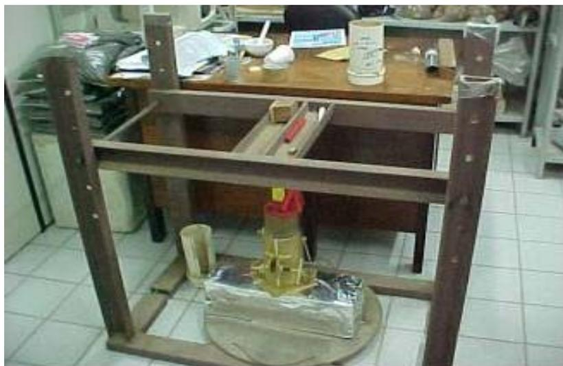
**Figura 4** – Foto ilustrativa do Sistema de Compactação Hidromecânico de solo desenvolvido no Departamento de Energia Nuclear.
