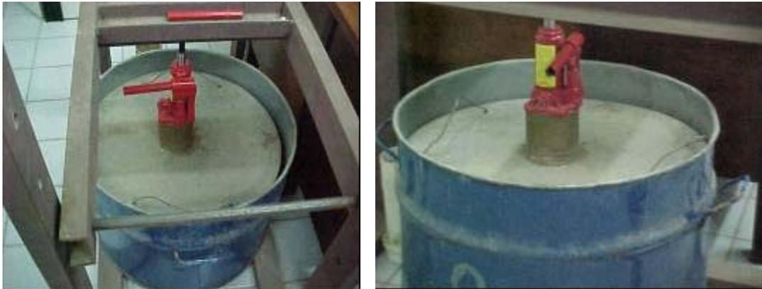
**Figura 6** – Vista lateral do Sistema de Compactação Hidromecânica de solo, desenvolvido no Departamento de Energia Nuclear.
