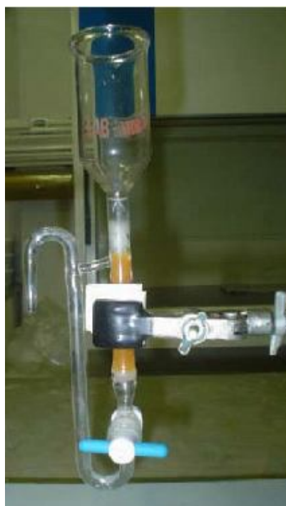
Figura 6 - Detalhe da coluna de vidro de troca iônica (ARAÚJO, 2005).
