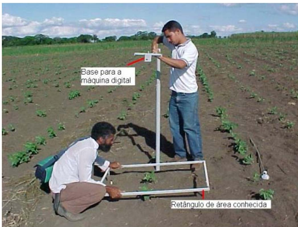
Foto 4- Dispositivo para medir a área ocupada pelas plantas do feijão caupi, onde se vê o retângulo sendo colocado no solo, além da base para a máquina fotográfica.
