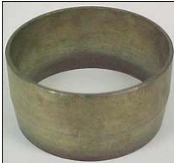
Foto 2- Infiltrômetro de anel simples
