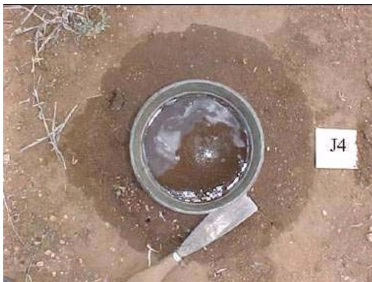
Figura 9. Teste de infiltração tridimensional com infiltrômetro de anel (150 mm de diâmetro).
