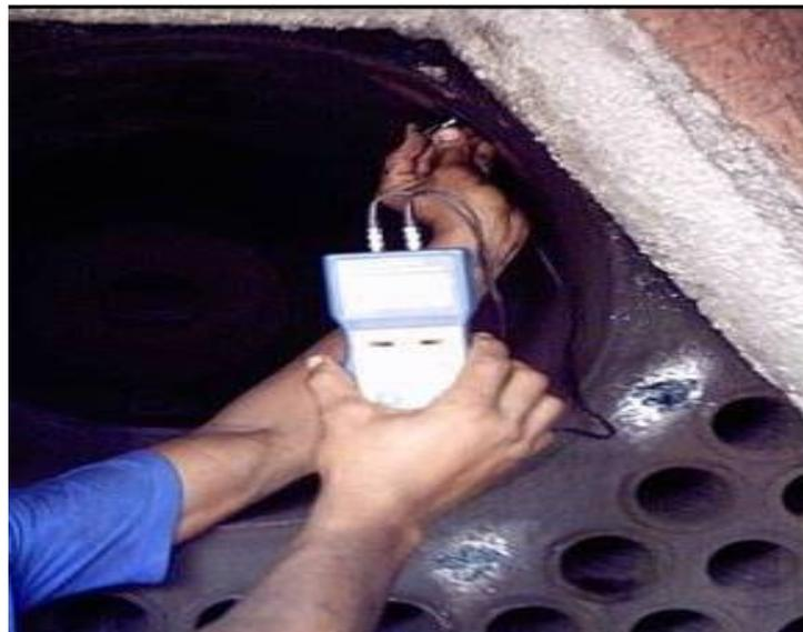
Figura 8. Medida da condutividade térmica para verificar a espessura da incrustação.
