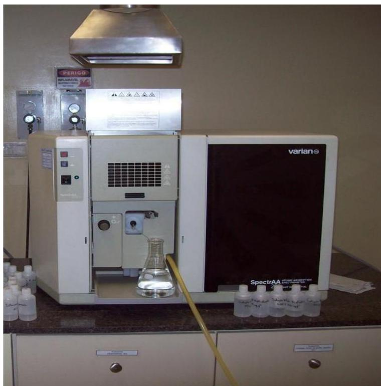
Figura 6. Espectrometria de absorção atômica
