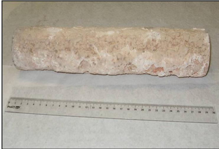
Figura 7. Incrustação produzida numa tubulação de água, seccionada de uma caldeira.
