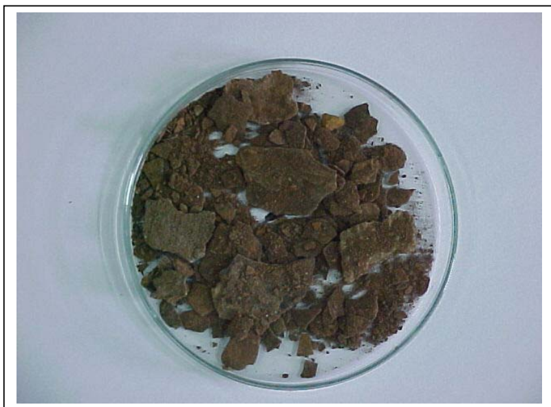
Figura 14 Amostra 11 retirada de tubulação de água produzida da Estação Coletora Sítio Novo
