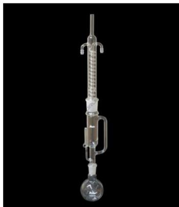
Figura 5: Aparelho de Soxhlet utilizado para fazer a extração da fração lipídica.
