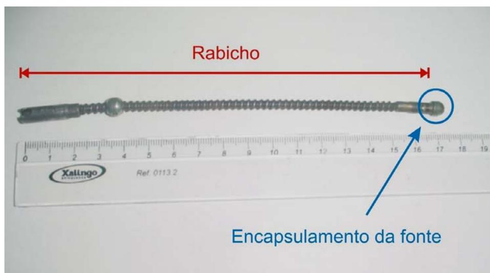
**Figura 21.** Encapsulamento e conexão de uma fonte de  $^{192}\text{Ir}$ .
