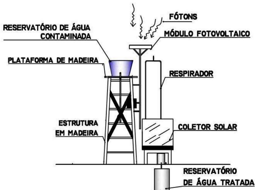
Figura 30. Diagrama frontal do pasteurizador solar automático.
