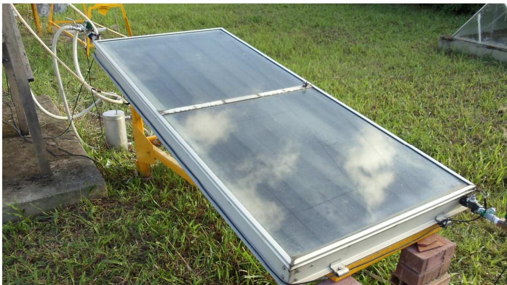
**Figura 6. Coletor solar plano utilizado no protótipo.**
