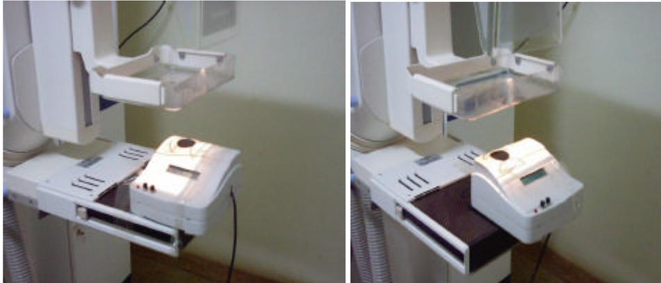
**Figura 43: Variações do posicionamento do MAMO-KVDT-01 no equipamento mamográfico.**
