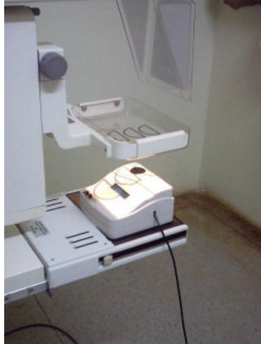
**Figura 42: Posicionamento do MAMO-KVDT-01 no equipamento mamográfico.**
