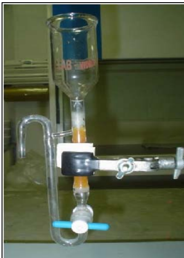
Figura 12. Coluna de vidro de troca iônica (GODOY et al., 1998).
