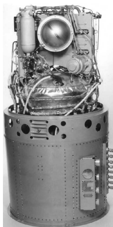
Figura 1.1: Célula a combustível utilizada pela nave Apolo11 para o fornecimento de energia elétrica (1,5 kW) e água potável.
