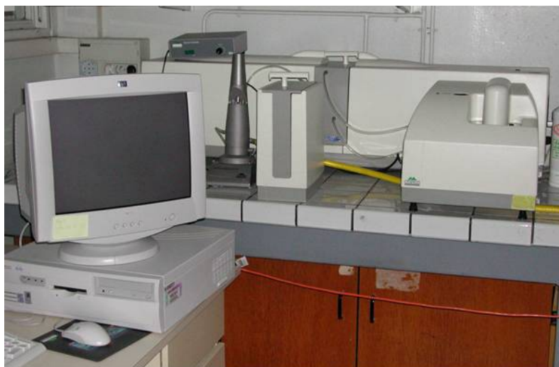
Foto A.1 - Granulômetro a laser, modelo Malvern Mastersizer 2000 (Malvern Instruments Ltda –Inglaterra) do LTHE (Laboratoire d'étude des Transferts em Hydrologie et Environnement - Grenoble).
