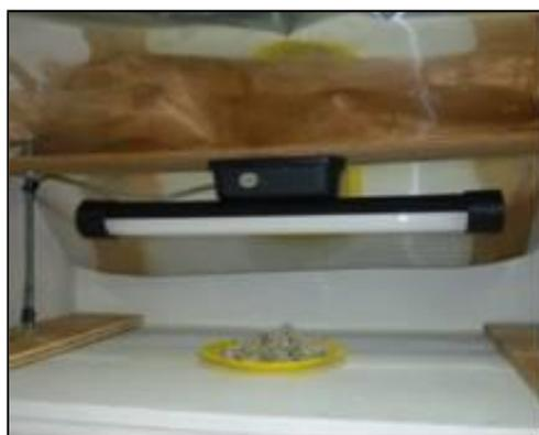
**Figura 9** - Irradiação UVB em lâmpada Philips Ultraviolet B – 20W. Foto: Helena Silva (2009).
