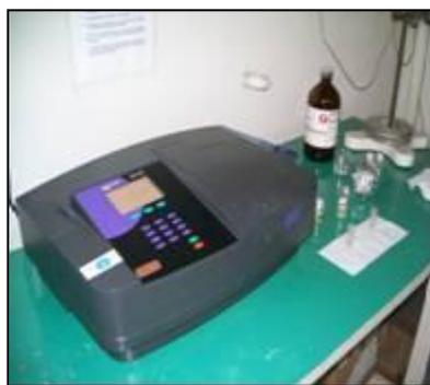
**Figura 14** - Espectrofotômetro BIOCHROM<sup>®</sup> modelo Libra S 22. Foto: Helena Silva (2010).
