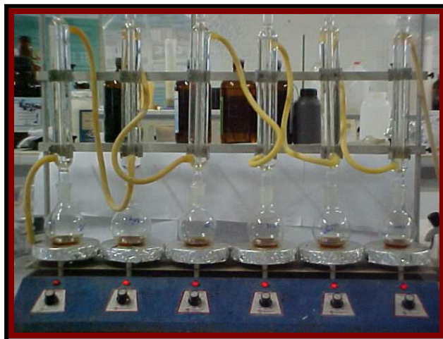
Figura 3.2 – Sistema de aquecimento para oxidação do carbono orgânico total no solo
