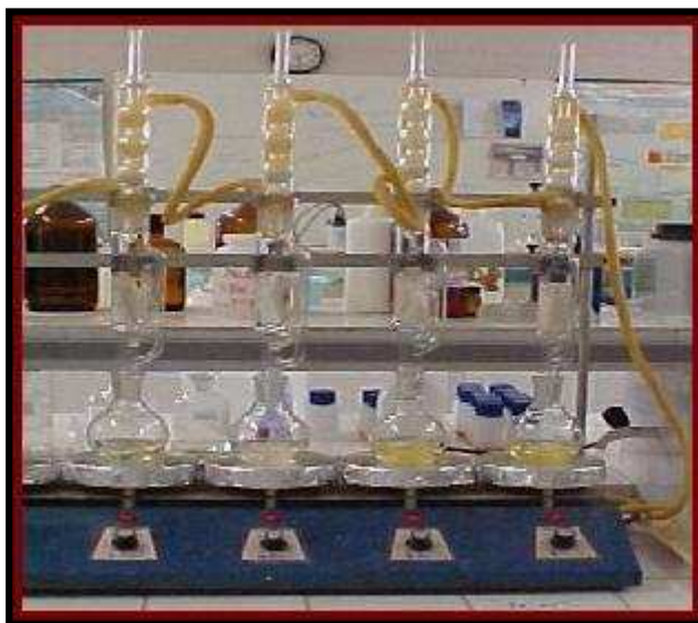
Figura 3.3 – Extrator soxhlet utilizado para remoção dos HPA no solo
